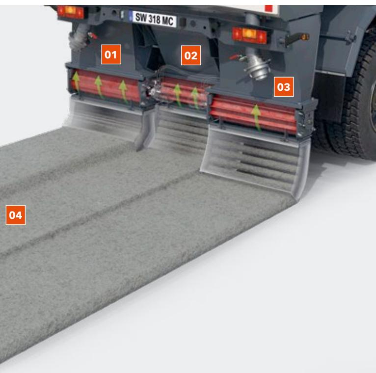
**01** Durch das Streuen in Teilbreiten kann eine Überlappung des Streuguts nahezu ausgeschlossen werden.
