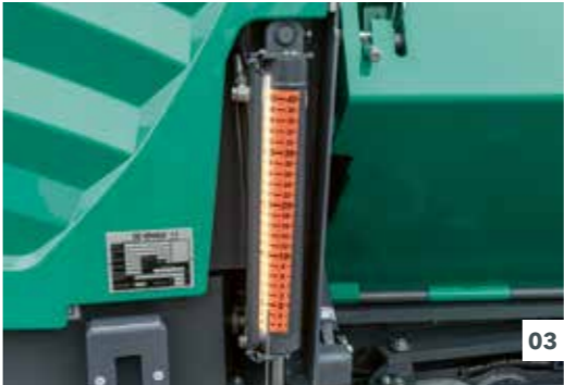
01 Ideale Ausleuchtung des Arbeitsbereichs. 02 Perfekte Ausleuchtung des Bedienstands. 03 Optimale Beleuchtung der Nivellierzylinder.
