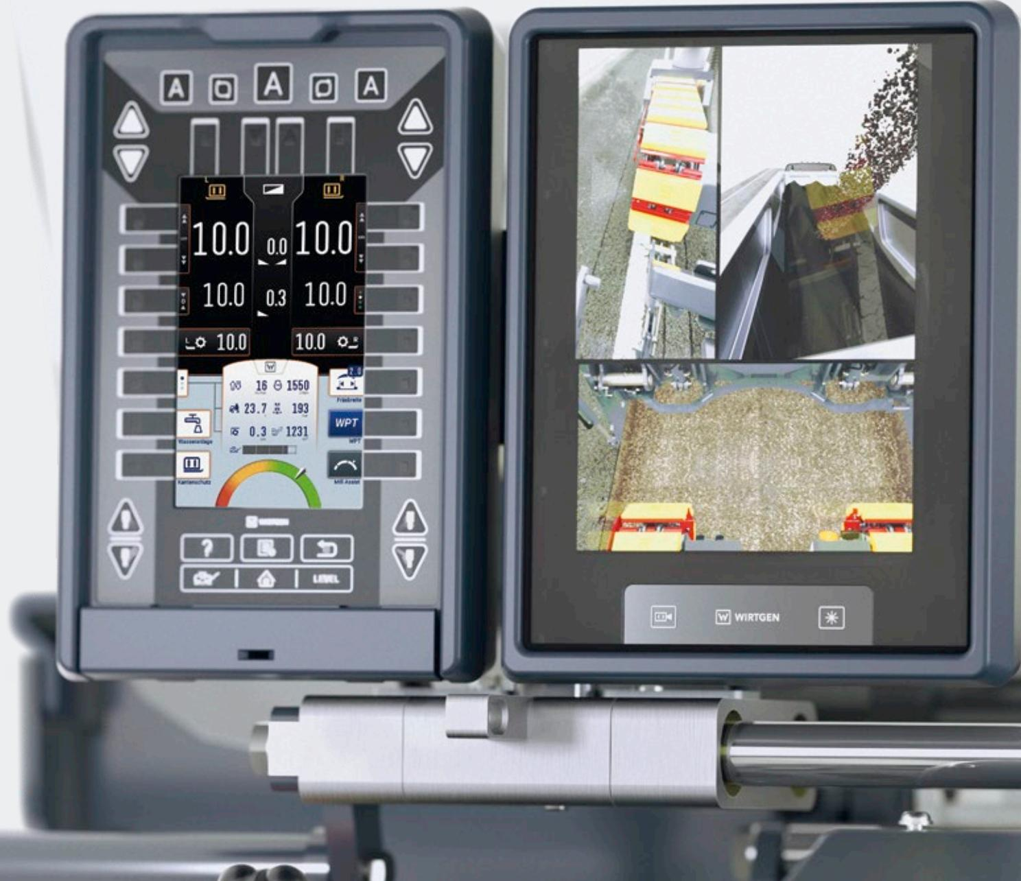
**01** 10"-Bedienpanel mit Split Screen zur gleichzeitigen Anzeige mehrerer Kamerabilder.
