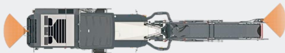
**2-fach-Kamerasystem:** Kamera Heckbereich / Kamera Verladesituation
