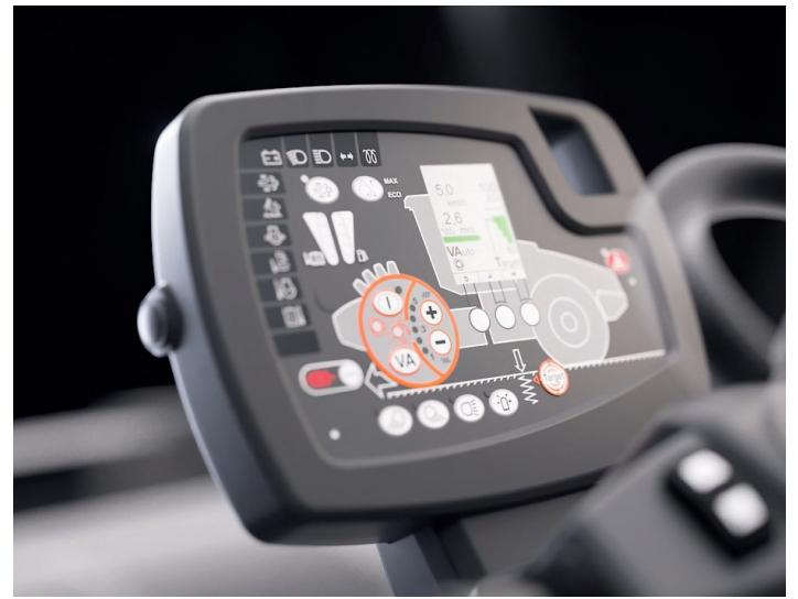
Der Automatikmodus wird ebenso wie der Zielverdichtungswert über das bekannte Easy Drive Display aktiviert.
