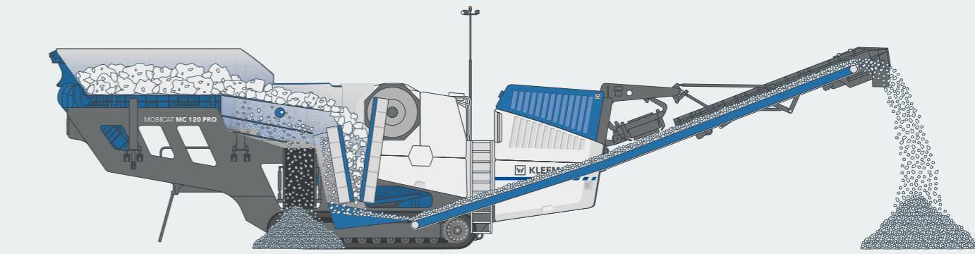
La MOBICAT MC 120 PRO cuenta con una unidad de alimentación de grandes dimensiones gracias a la cual se pueden alimentar grandes cantidades de material sin problemas con una excavadora o una pala cargadora. El elevado rendimiento de la instalación se observa también en las dimensiones de la boca de la machacadora y en el diseño extralargo de la mandíbula trituradora
