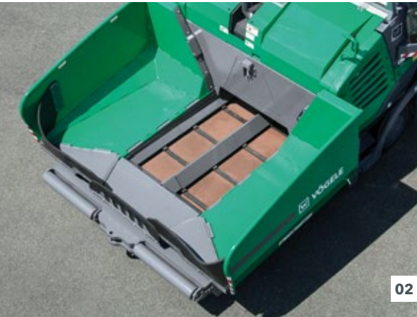
01 Alas de tolva operadas de manera independiente. 02 La gran tolva receptora tiene una capacidad de 13 toneladas métricas (14,3 toneladas cortas).
