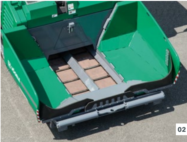
01 Ailes de trémie à commande indépendante. 02 La grande trémie réceptrice offre une capacité de 13 tonnes (14,3 tons).
