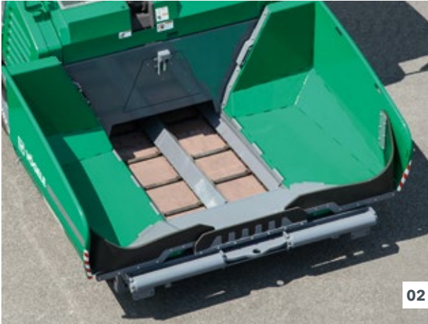
01 Alas de tolva operadas de manera independiente. 02 La gran tolva receptora tiene una capacidad de 13 toneladas métricas (14,3 toneladas cortas).
