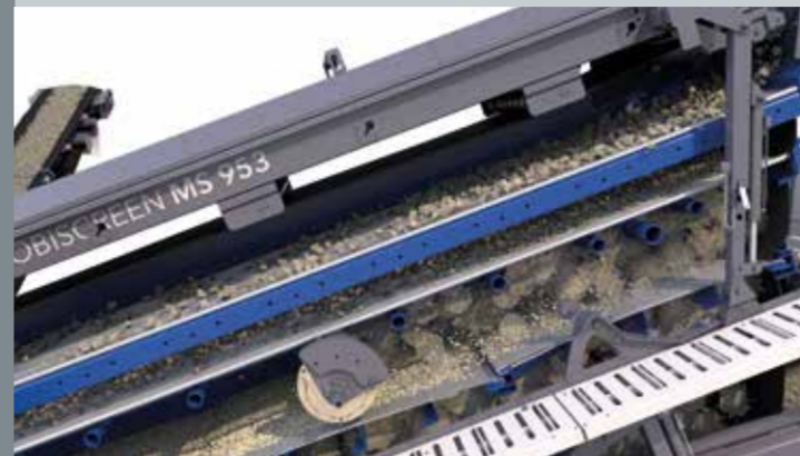
Instalación con 2 o 3 cubiertas
