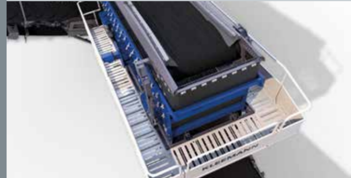
Acceso con plataforma de trabajo perimetral
