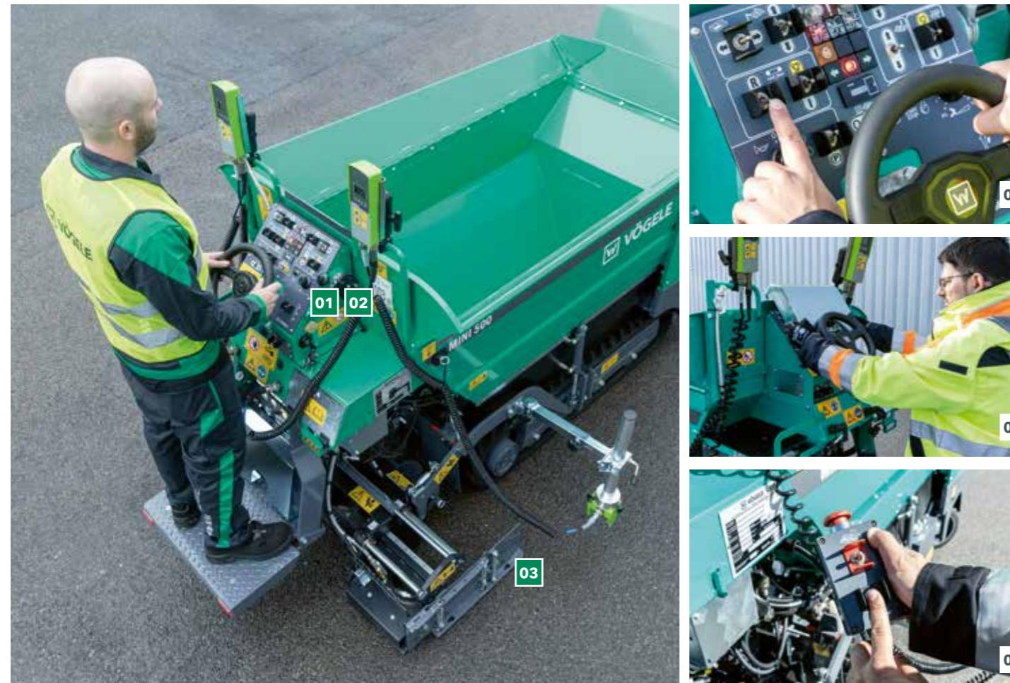
Даже при прокладке узких дорожек перед рабочими стоит цель добиться максимальной ровности. Для MINI 500 и MINI 502 VÖGELE предлагает простую в управлении систему автоматического нивелирования. Ее функционал адаптирован под область применения укладчиков MINI
