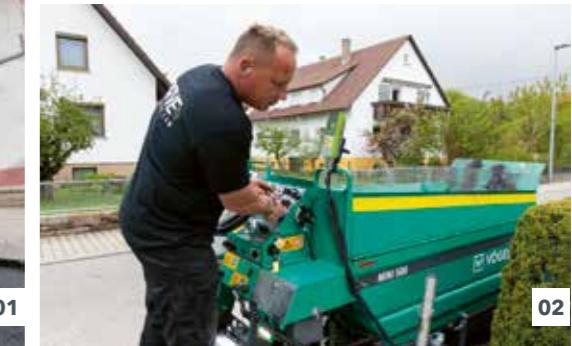
**01** Мини-укладчики превосходно подходят для укладки асфальта между рельсами либо в полосы после фрезерования.
