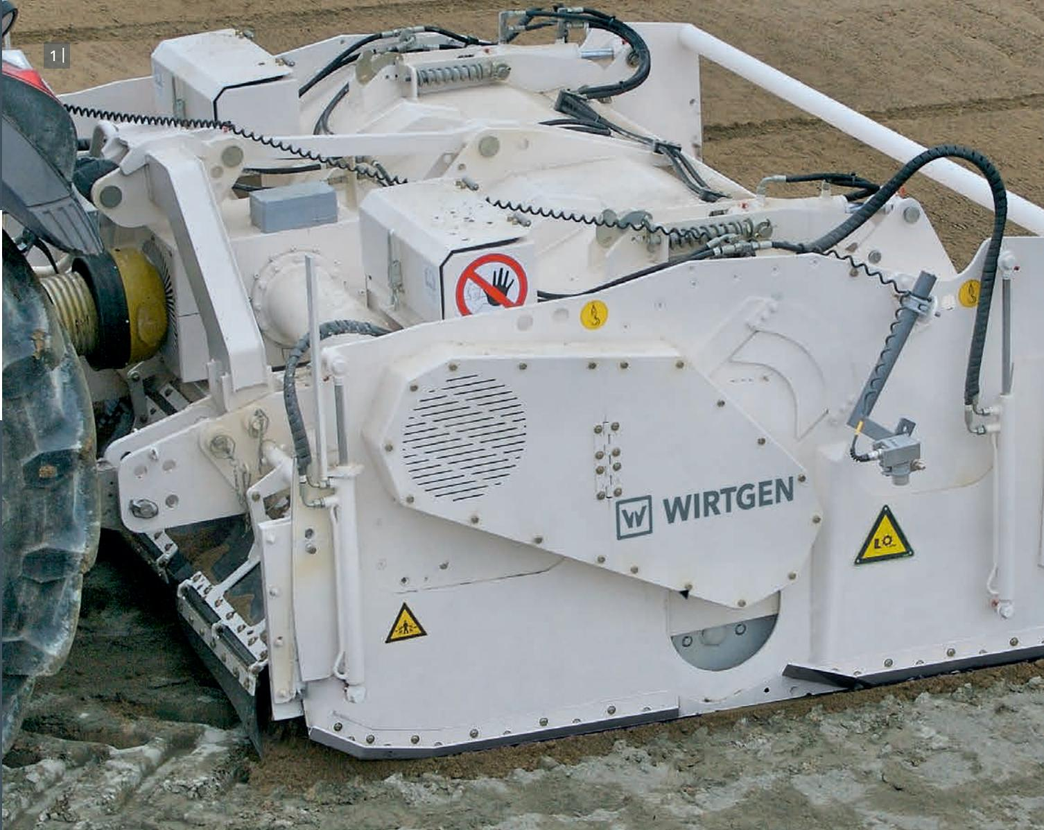
1 | В грунте находится только фрезерно-смесительный барабан. Текущая глубина фрезерования контролируется с помощью цифрового индикатора рабочей глубины.
