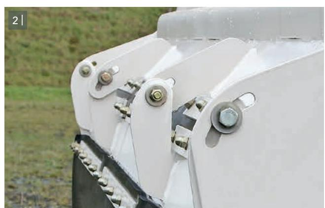
2 | Регулировка зачистного скребка выполняется механически через продольные отверстия.
