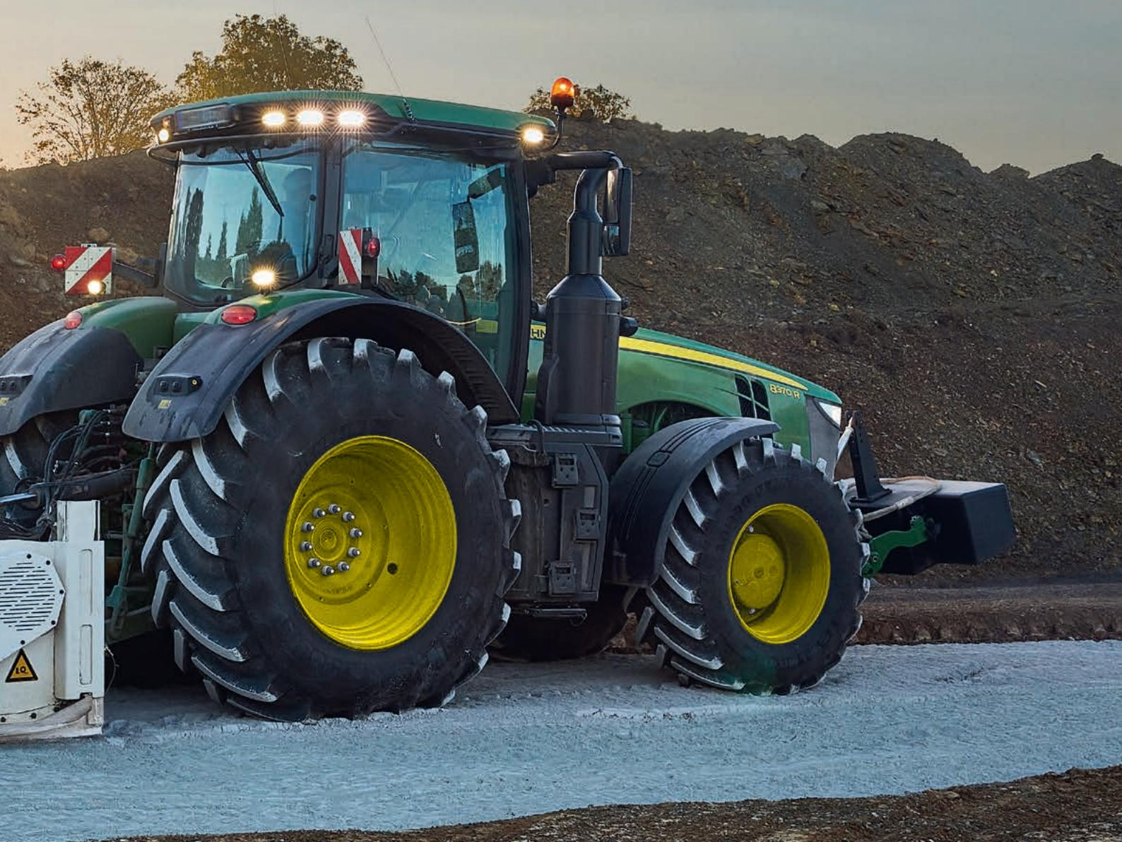
Навесные стабилизаторы WS 220 и WS 250 служат для эффективной стабилизации грунта с рабочей шириной 2,15 м и 2,5 м.
