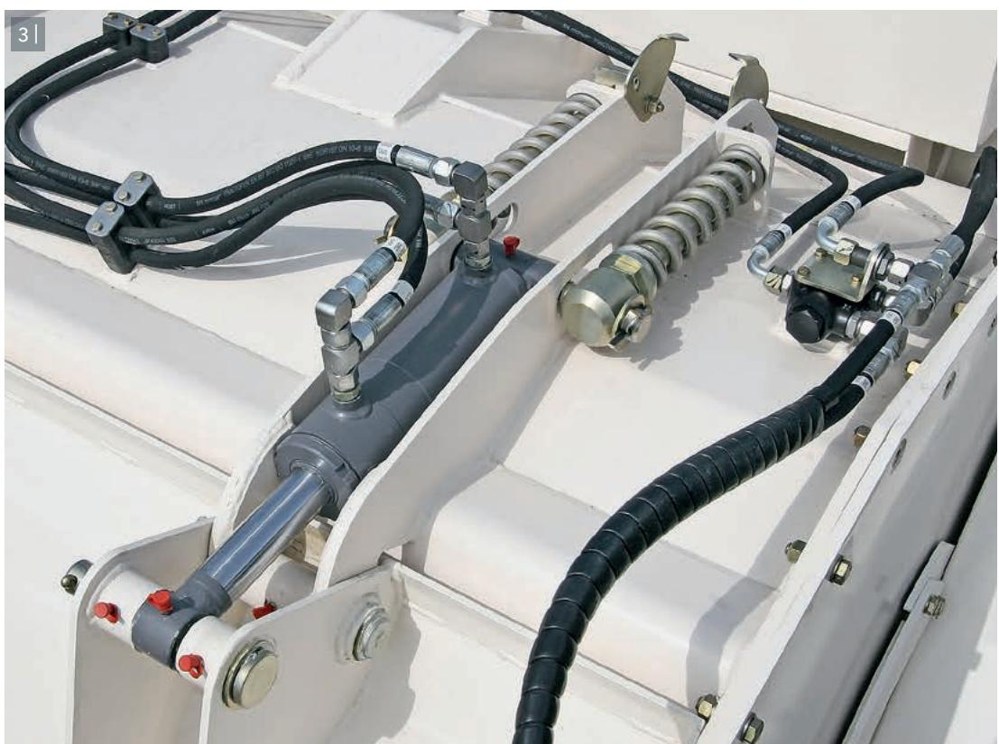
3 | Пакеты длинных пружин для обеспечения оптимального давления прижима заднего щита барабана.
