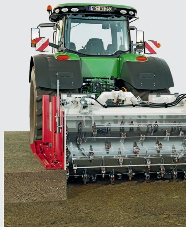
2 | Боковой щит в комбинации с механическим упором гарантирует постоянную рабочую глубину.
