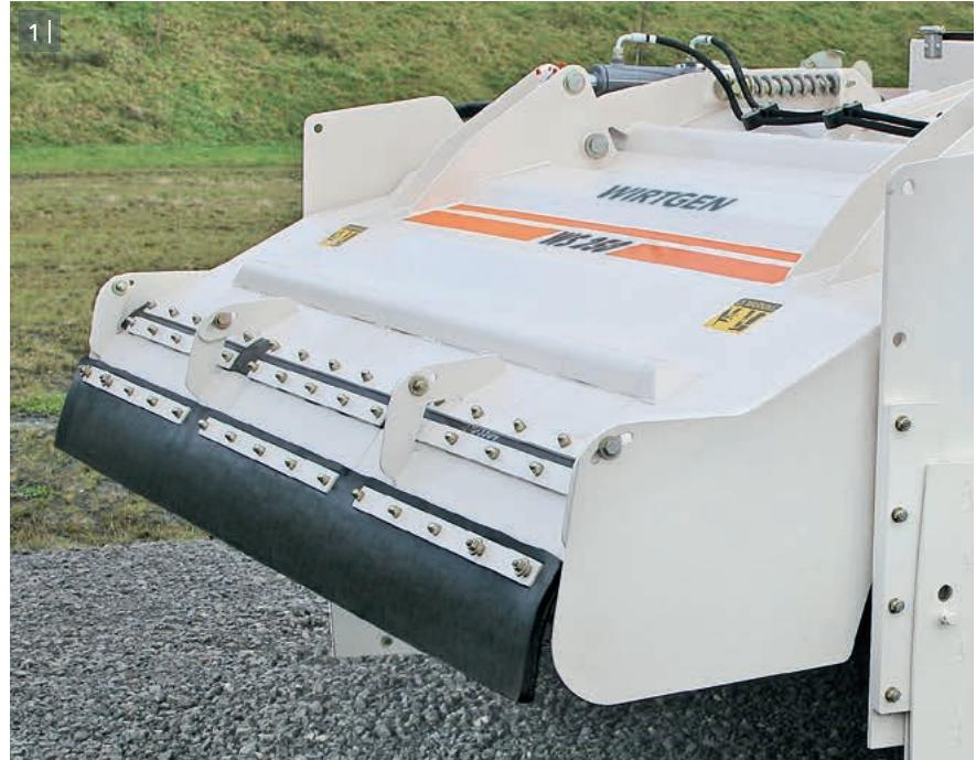
1 | Комбинация из заднего щита с пружинами и регулируемого зачистного скребка обеспечивает наилучшие результаты по ровности.
