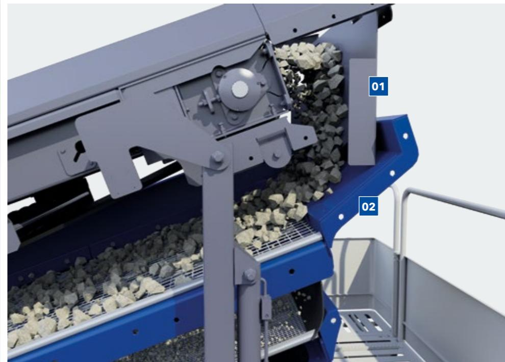
para trás e o salto de pedras. Os freios do material (opção) na peneira prolongam o tempo de permanência do material e evitam que o material de alimentação salte no deck superior. Estes dois elementos, dependendo do material de alimentação, garantem um transporte uniforme do material.
