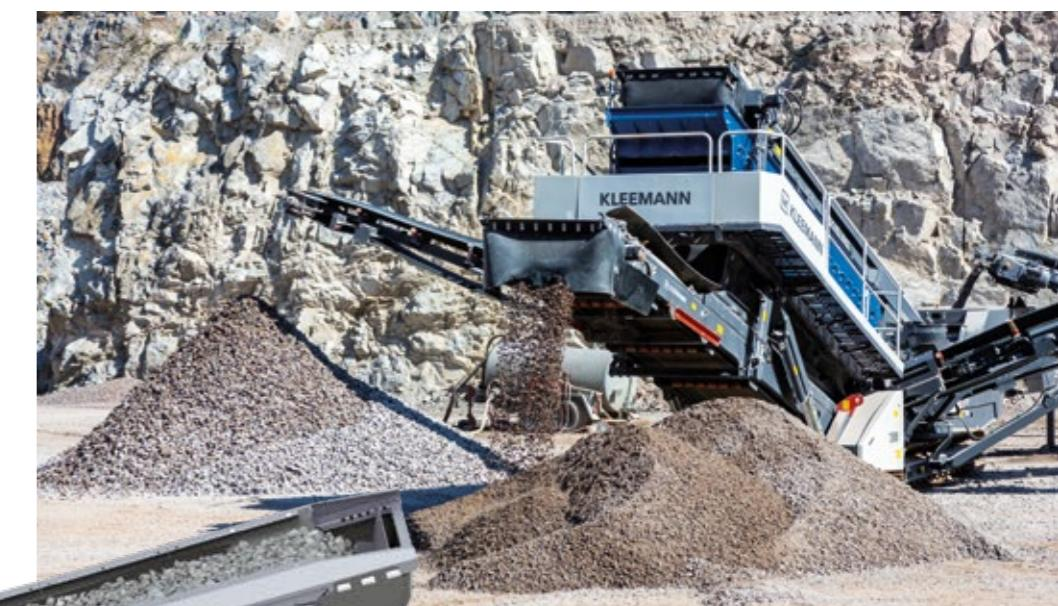
**i** Die MSC EVO Siebanlagen verfügen optional über einen Hydraulik-Port zum Betreiben eines hydraulisch angetriebenen Haldenbandes.
