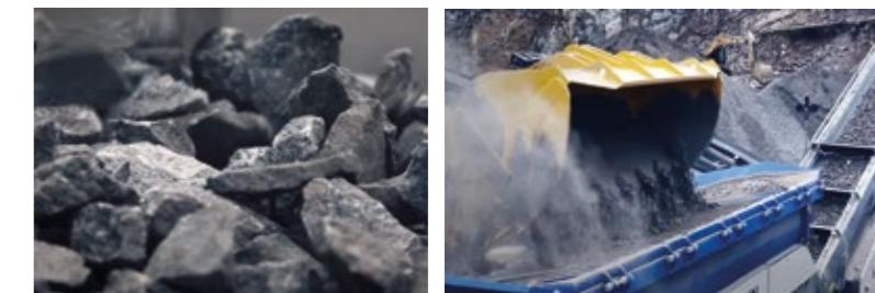
**Der Aufgabetrichter der MSC EVO Klassiersiebanlagen ist großzüig dimensioniert und für einen optimalen Materialfluss ausgelegt.**
