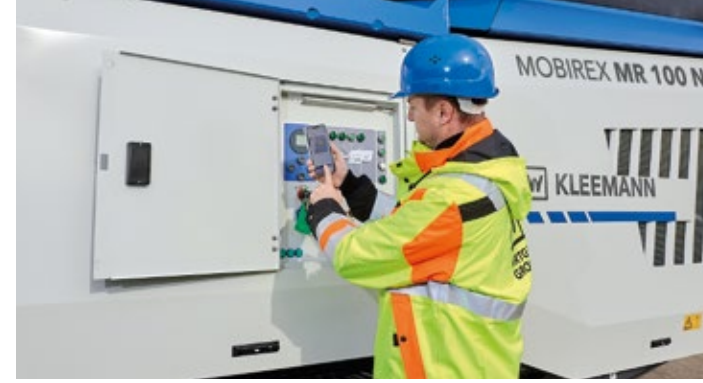
1. Makine ekranından erişim verilerini tarayarak MR 100 NEO'yu SPECTIVE CONNECT ile bağlayın.
