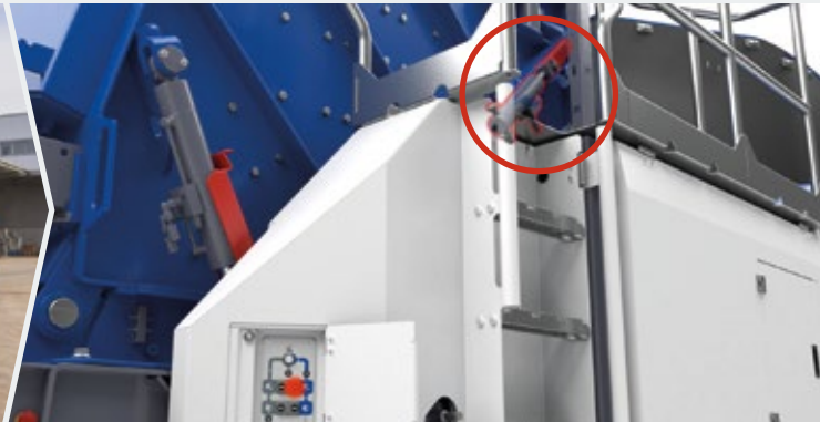
...и гидравлическим способом происходит вытягивание клиньев для блокировки корпуса дробилки.
