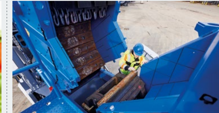
> Дробилка полностью открыта для доступа с обеих сторон для выполнения работ по сервисному и техническому обслуживанию. Замена бил выполняется сверху без каких-либо проблем.
