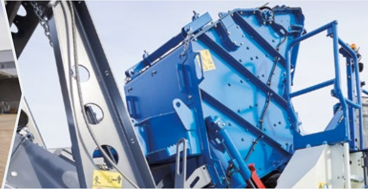
...до полного открытия дробилки. Дополнительно срабатывает механический предохранитель.
