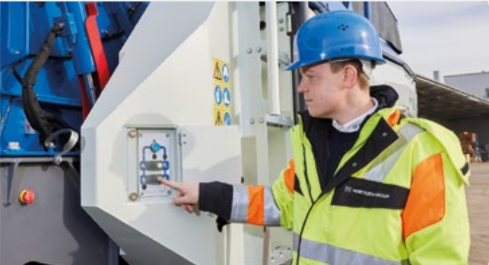
> Abertura automática da carcaça do britador mantendo o botão pressionado...
