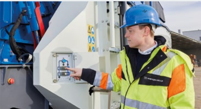
> o britador é desbloqueado por acionamento de botão...
