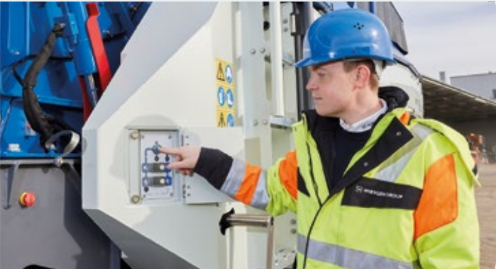
> Por acionamento de botão é atribuída a liberação do dispositivo de bloqueio e rotação do rotor...
