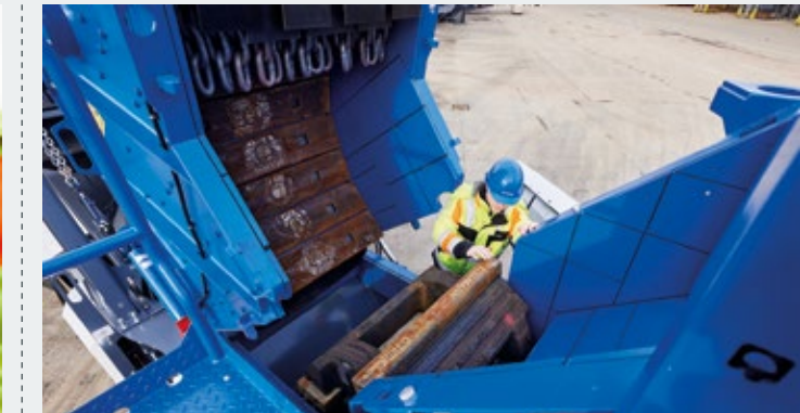
> O britador está completamente aberto de ambos os lados para permitir a melhor acessibilidade para assistência técnica e manutenção . A substituição da travessa de impacto é feita de forma simples a partir de cima.
