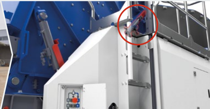
...e as cunhas são puxadas hidráulicamente para o bloqueio da carcaça do britador.
