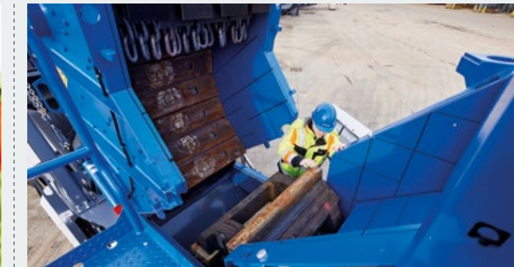
> Kruszarka jest całkowicie otwarta, co zapewnia możliwie najlepszy dostęp do serwisu i konserwacji z obu stron. Wymiana płyt uderowych odbywa się w łatwy sposób od góry.
