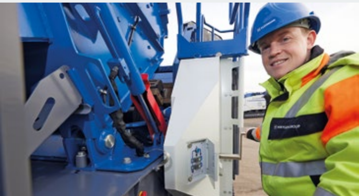
> Wirnik jest ustawiany na pozycji w celu kontroli zużycia lub wymiany płyty uderowej.
