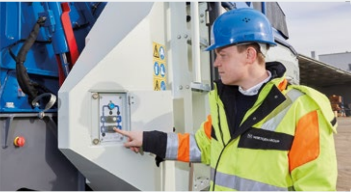
> Automagiczne otwarcie obudowy kruszarki przez naciśnięcie i przytrzymanie przycisku...
