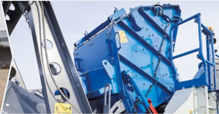
... aż nastąpi pełne otwarcie kruszarki. Dodatkowo zatrząskuje się zabezpieczenie mechaniczne.
