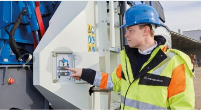
> Kruszarka jest odblokowywana przyciskiem...
