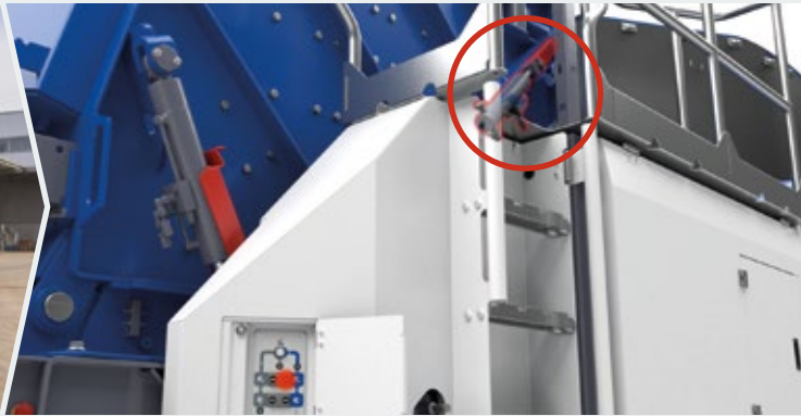
... a kliny blokujące obudowę kruszarki są ciągnięte hydraulicznie.
