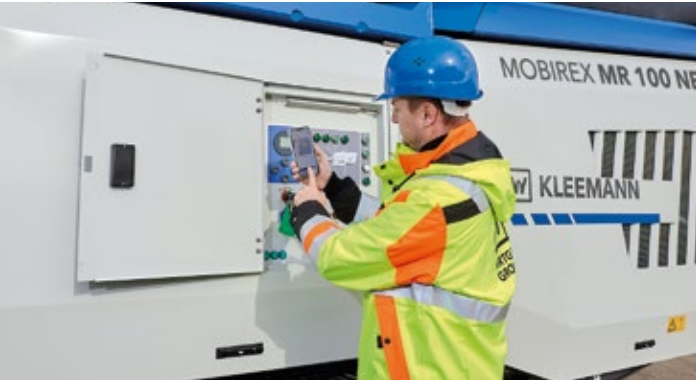
1. Połączenie kruszarki MR 100 NEO z systemem SPECTIVE CONNECT poprzez proste zeskanowanie danych dostępu z ekranu maszyny.
