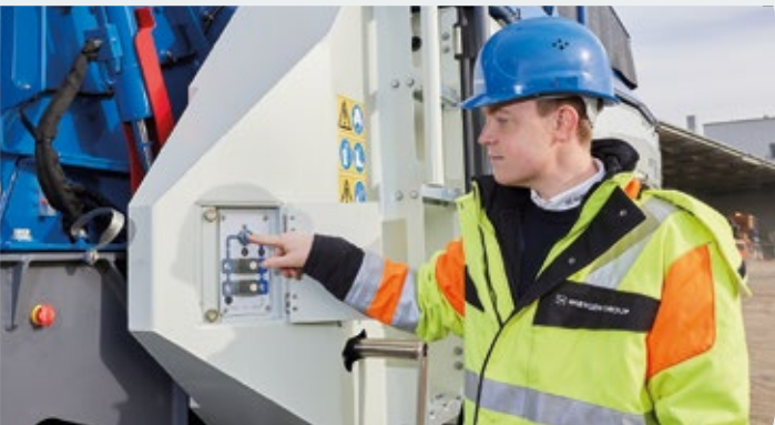
> Urządzenie blokujące i obracające wirnik jest zwalniane jednym naciśnięciem przycisku....
