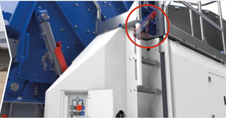
... e i cunei per il bloccaggio dell'alloggiamento del frantoio vengono tirati idraulicamente.
