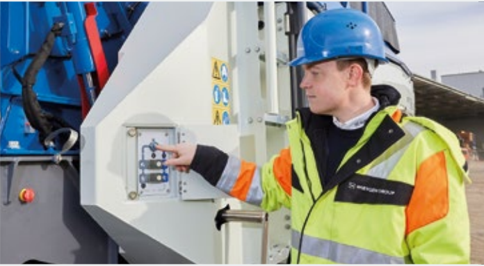
> Il dispositivo di bloccaggio e rotazione del rotore si sblocca premendo un pulsante...
