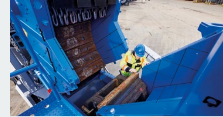
> Il frantoio è completamente aperto, per garantire la migliore accessibilità per l'assistenza e la manutenzione da entrambi i lati. I martelli vengono facilmente sostituiti dall'alto.
