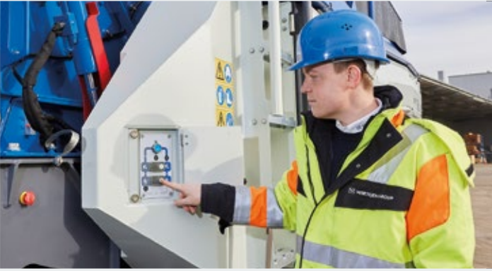
> Apertura automatica dell'alloggiamento del frantoio tenendo premuto un pulsante...
