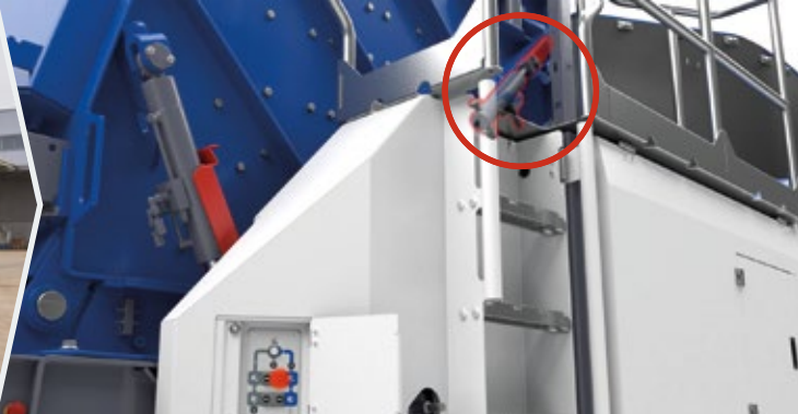
...et les cales de verrouillage du bâti du broyeur sont tirées hydrauliquement.
