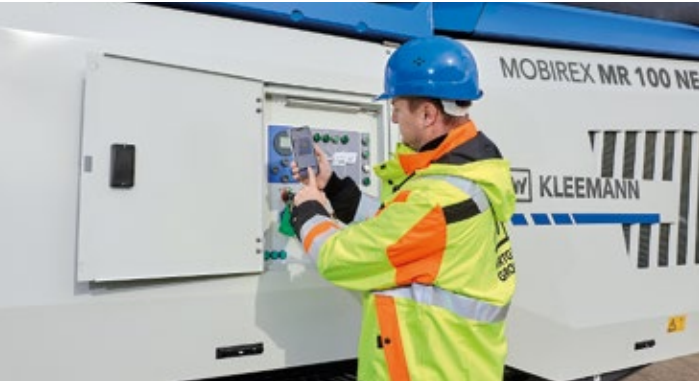
1. Raccordement du MR 100 NEO avec SPECTIVE CONNECT en scannant simplement les données d'accès depuis l'écran de la machine.
