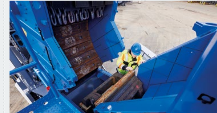
> Le broyeur est complètement ouvert afin d'assurer un accès optimal pour le service et la maintenance des deux côtés. Le remplacement des battoirs s'effectue simplement par le haut.
