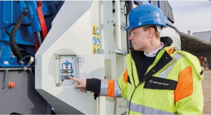
> Ouverture automatique du bâti du broyeur en maintenant le bouton enfoncé...
