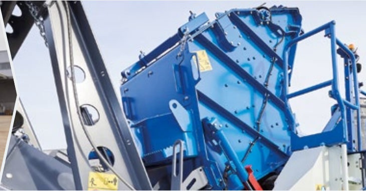
...jusqu'à ce que le broyeur s'ouvre complètement. La sécurité mécanique s'enclenche également.
