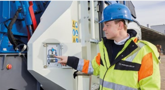
> La trituradora se desbloquea pulsando un botón...
