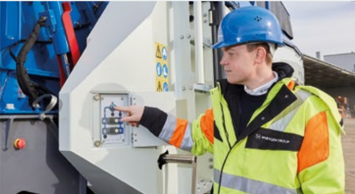
> Pulsando un botón se libera la dirección de giro y bloqueo del rotor...
