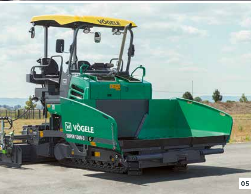
01 Simplicité d'utilisation grâce au système de conduite ErgoBasic innovant. 02 Finisseur sur chenilles avec un large champ d'applications. 03 Grâce à sa faible largeur et à sa longueur totale compacte, ce finisseur est très facile à utiliser et à manier sur les chantiers exigus.
