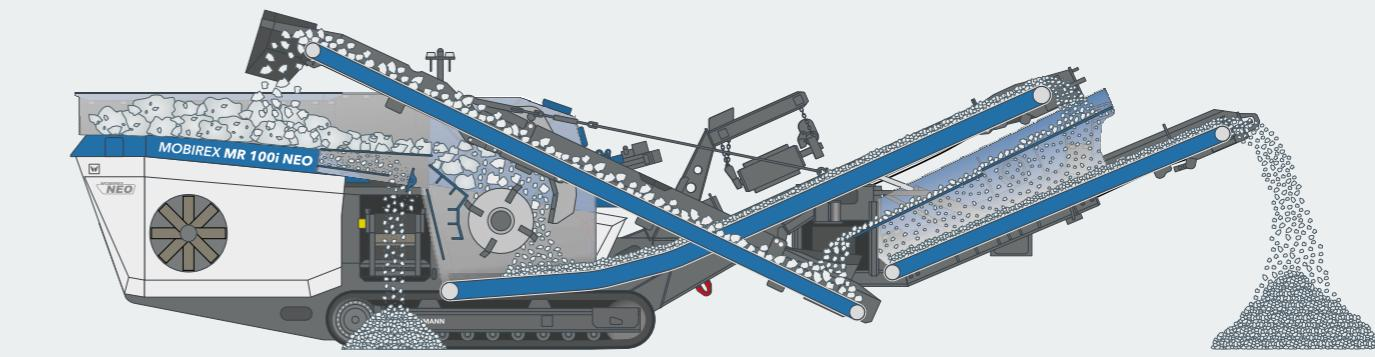
MR 100(i) NEO / NEOe отличается очень высоким качеством конечного продукта, что обеспечивается не только высокопроизводительным дробильным агрегатом, оснащённым ротором с 4 билами (с большой рабочей зоной и возможностью использования различных бил), но и опциональным однодековым сортировочным грохотом с рабочей поверхностью 4 м<sup>2</sup>. Всё это позволяет получать конечный продукт нужной крупности. Благодаря встроенному возврату надрешётного продукта
