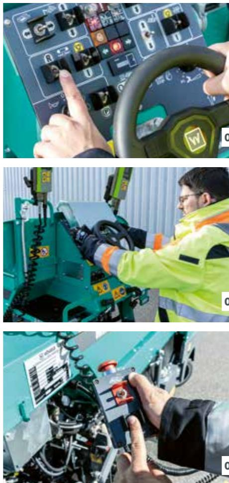
狭い道であっても、可能な限り平坦性を高めることを目指します。VÖGELE は、自動グレードおよびスロープコントロールのための簡単な操作システムを MINI 500 と MINI 502 用に提供します。機能の範囲は MINI ペーバの用途範囲と一致しており、特に簡単
