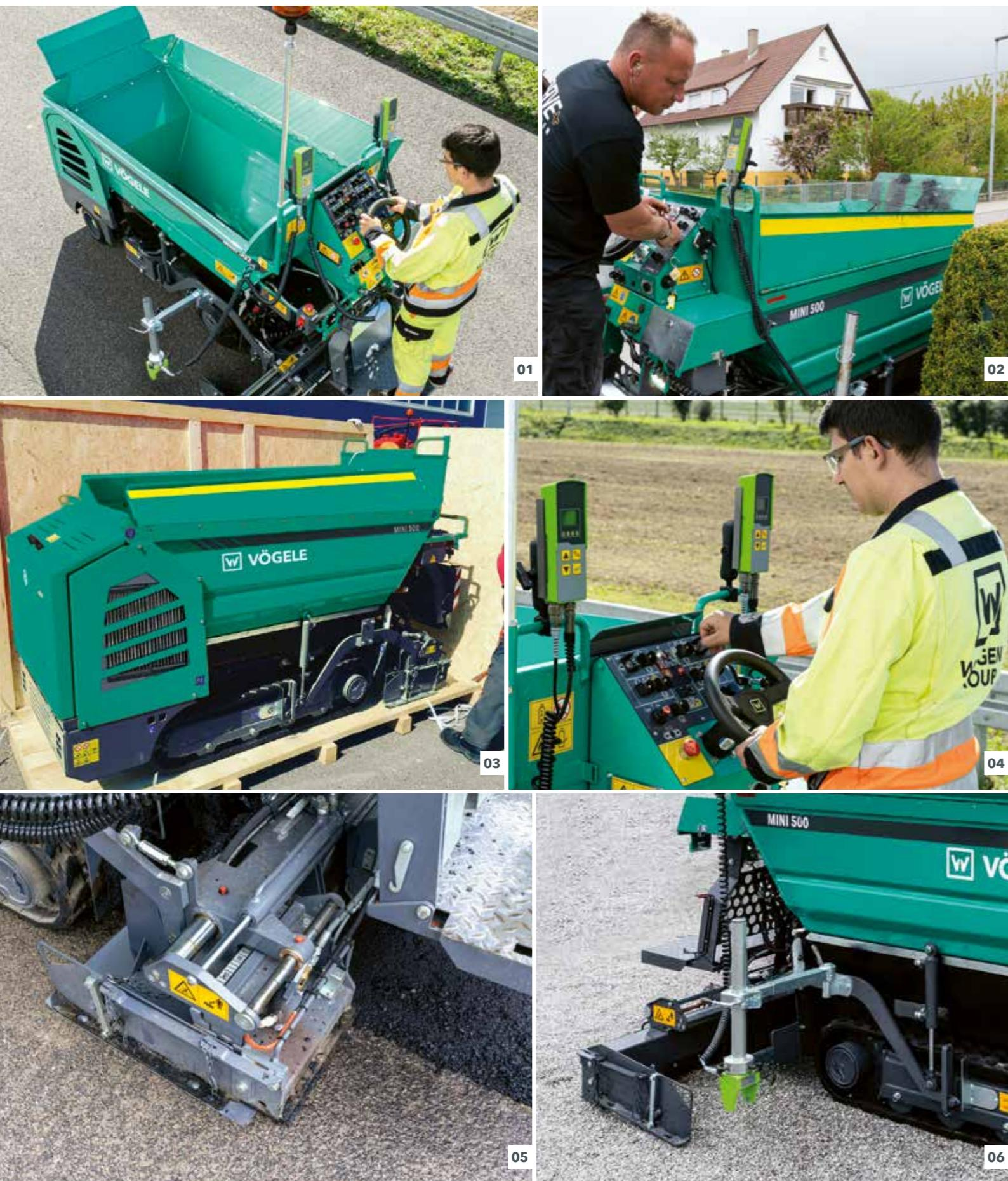
01 材料ホッパの最大容量は 1.2 トンで、最適な合材供給のための大きなホッパ開口部が備わっています。
