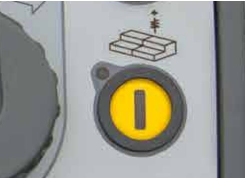
液压式熨平板助力功能 对于承载能力较差的材料, 液压式熨平板助力降低熨平板重量, 同时, 增加摊铺机牵引力。
