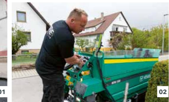
**01** As mini pavimentadoras são ideais para pavimentação asfáltica entre trilhos ou em pistas de fresagem.
