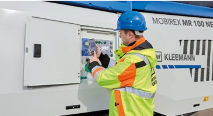
1. Verbinden der MR 100 NEO mit SPECTIVE CONNECT über einfaches Einscannen der Zugangsdaten vom Display der Maschine.
