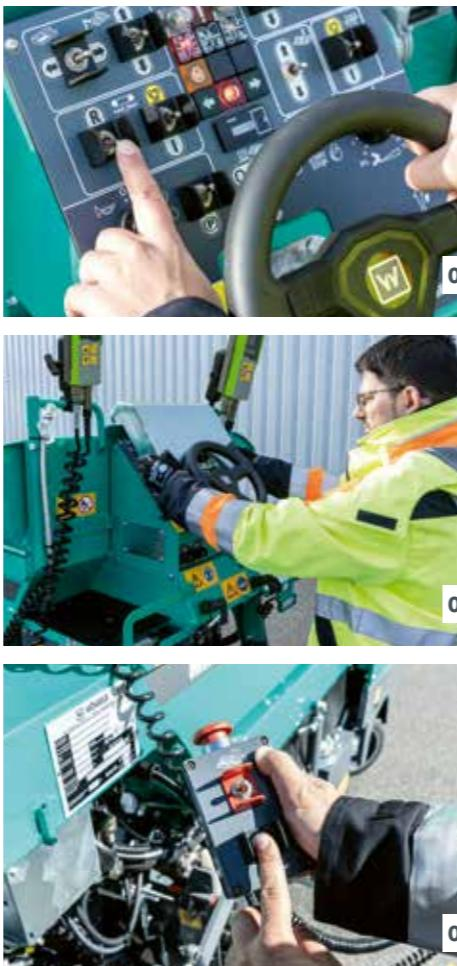
L'obiettivo è ottenere la massima planarità anche su opere viarie strette. Per la MINI 500 e la MINI 502, VÖGELE propone un dispositivo di livellazione automatica facilissimo da usare. Le funzionalità sono coordinate all'ambito di impiego delle
