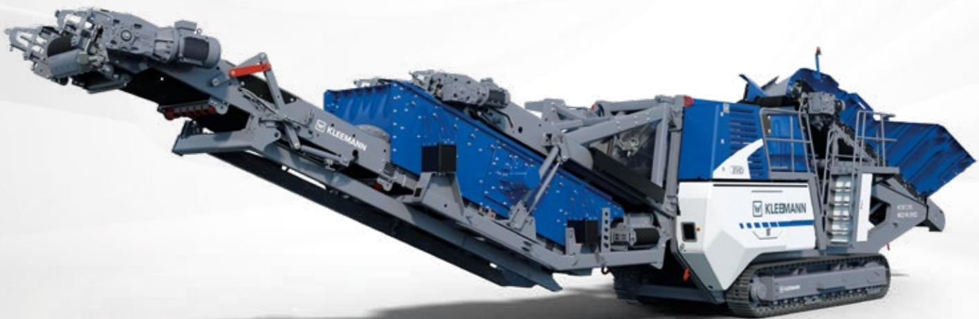
**Broyeur à cône mobile sur chenilles**
