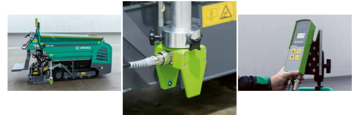
Auch bei schmalen Wegen ist höchste Ebenheit das Ziel. Für den MINI 500 und den MINI 502 bietet VÖGELE eine einfach zu bedienende Nivellierautomatik an. Der Funktionsumfang ist auf den Einsatzbereich der MINIs abgestimmt und
