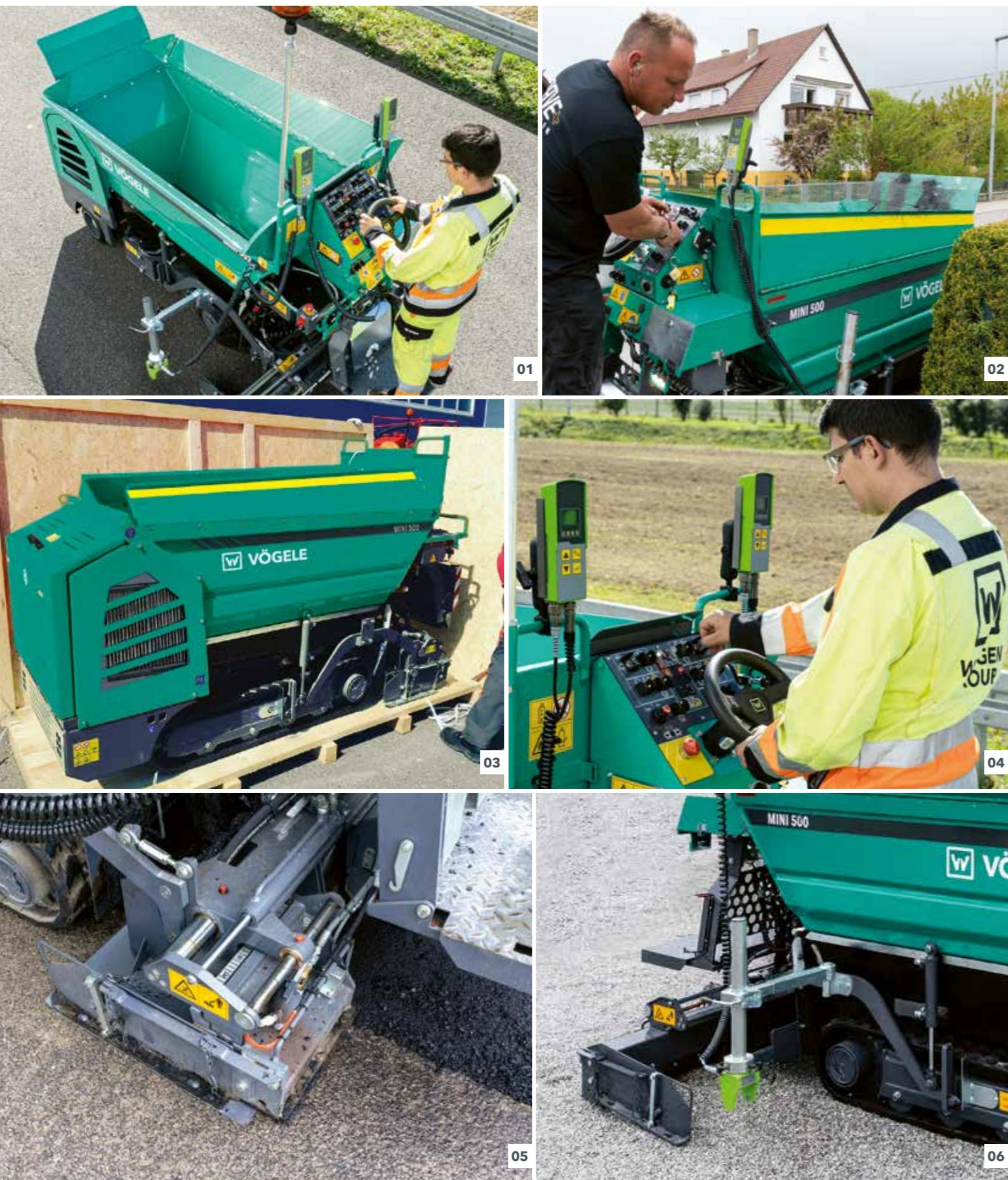
01 Materialbehälter mit einem Fassungsvermögen von bis zu 1,2 Tonnen und großer Trichteröffnung zur optimalen Beschickung.
