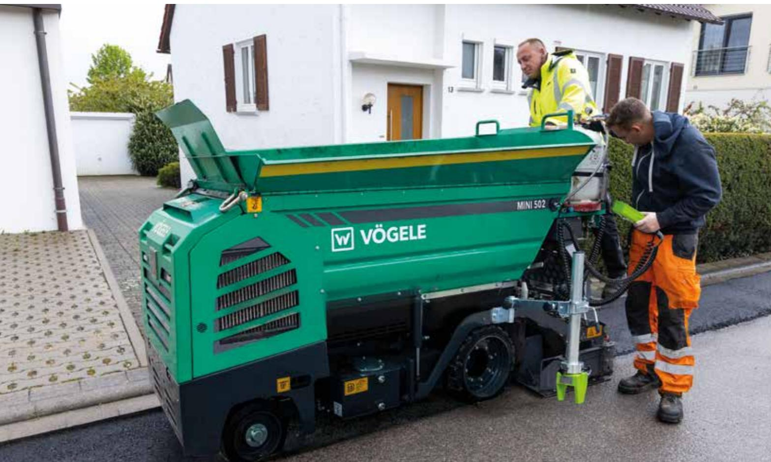
Dans de nombreuses situations de pose, le mode ECO (8 kW à 2 500 tr/min) suffit généralement. Le mode ECO réduit davantage la consommation de carburant et les émissions sonores. Deux puissants motoréducteurs sur les entraînements de translation assurent une conversion sans perte de la puissance d'entraînement en vitesse de pose. Un volant avec potentiomètre électronique soutient la direction assistée, ce qui facilite encore les manœuvres.
