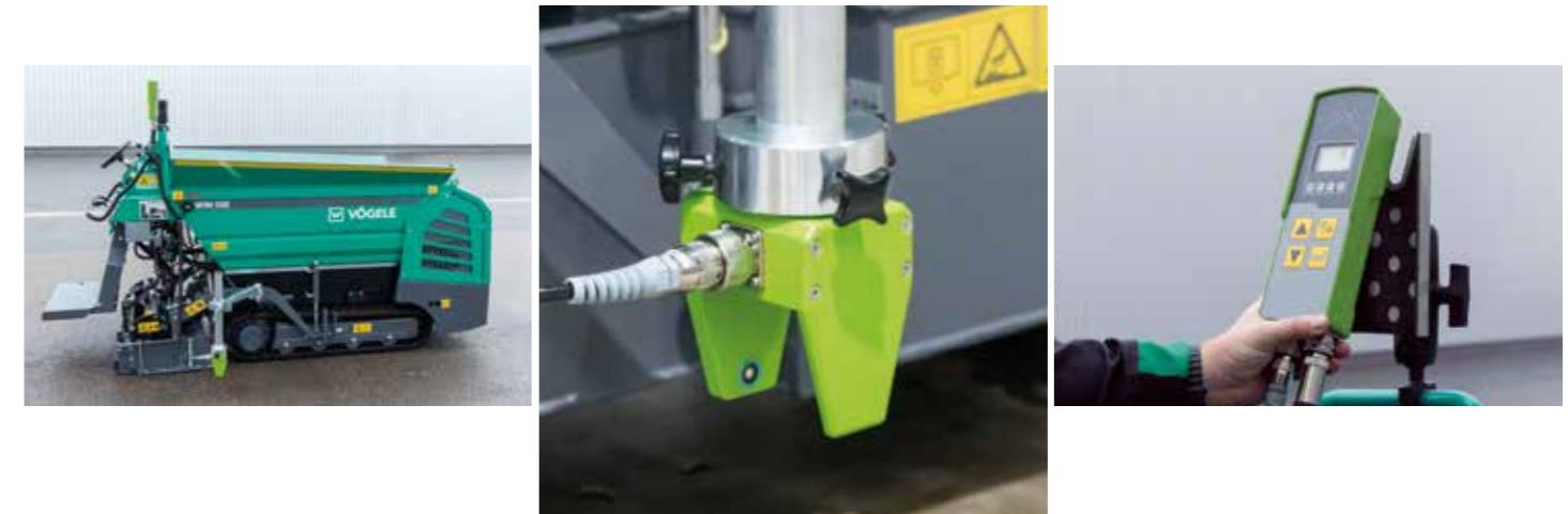
Même sur les chemins étroits, l'objectif est d'obtenir une planéité maximale. VÖGELE offre un système de nivellement automatique facile à utiliser pour les MINI 500 et MINI 502. L'étendue des fonctions est adaptée au domaine d'utilisation
