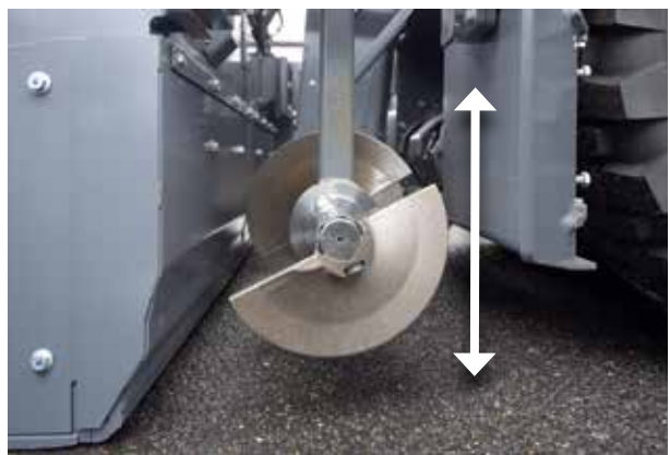
RELEVER/ABAISSE LA VIS DE RÉPARTITION
