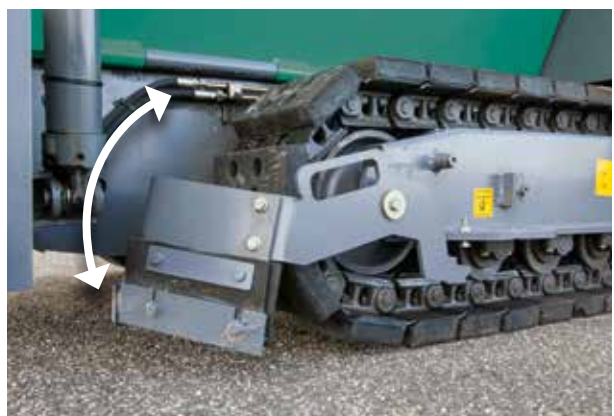
RELEVER/ABAISSE LES DÉFLECTEURS DES TRAINS À CHENILLES
