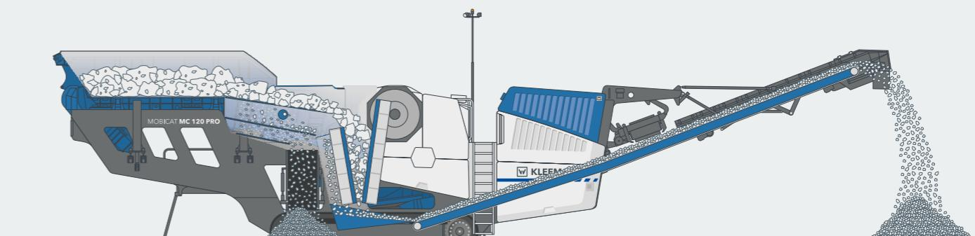
MOBICAT MC 120 PRO оборудована большим загрузочным бункером, благодаря чему возможна беспроблемная загрузка больших объёмов материала экскаватором или колёсным погрузчиком. О высокой производительности установки также можно судить по размерам загрузочного отверстия дробилки и удлинённой подвижной щеке. Это обеспечивает эффективное втягивание крупнокускового материала.
