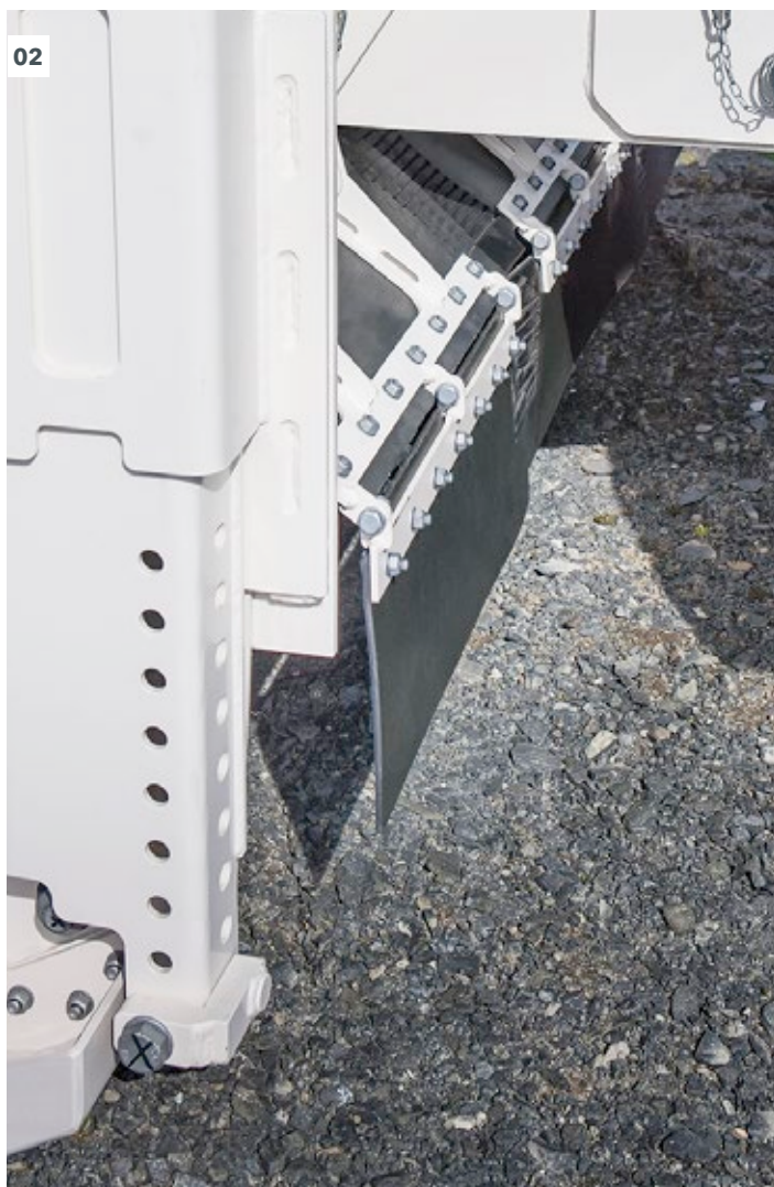
01 Le garde-boue fait ses preuves dans la pratique : il protège des impacts de graviers et réduit la formation de poussière.
