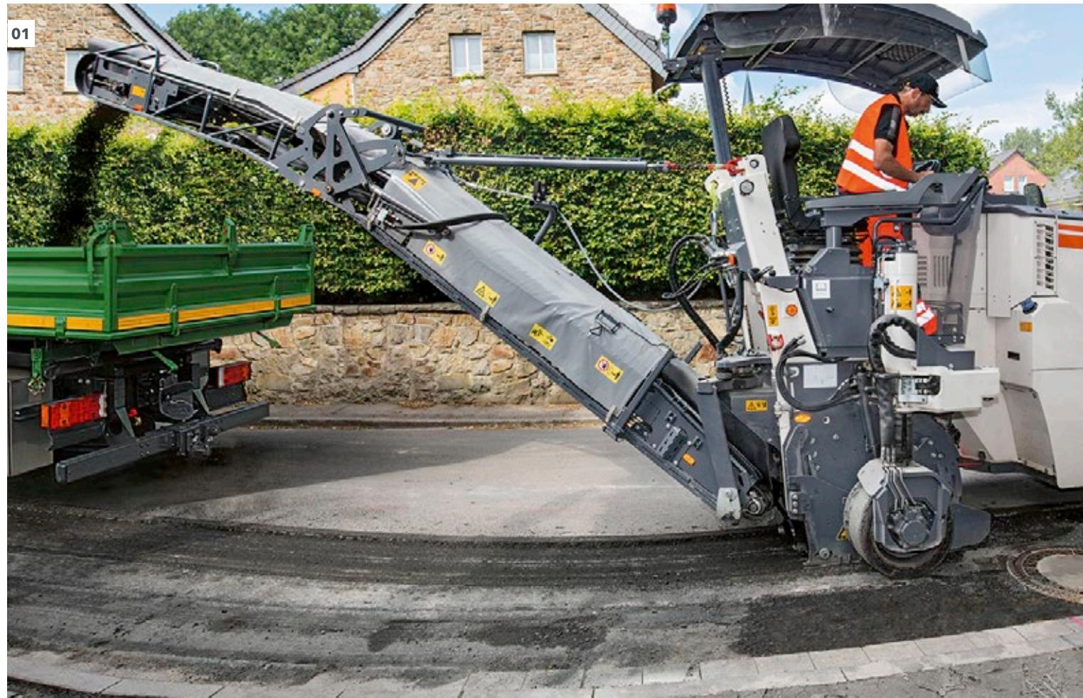
**01** A fresadora pequena oferece um carregamento de material potente e eficiente.
