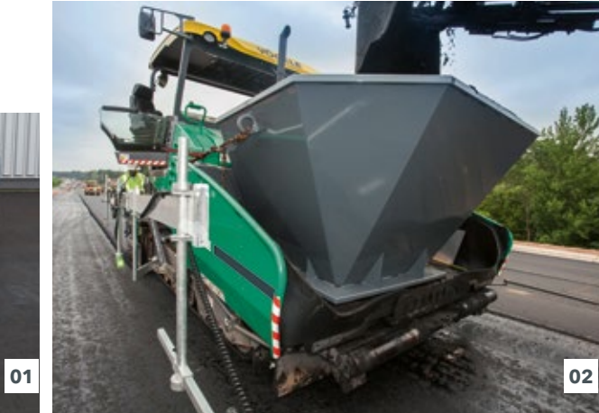
01 Ailes de trémie indépendantes. 02 Une trémie à insérer est disponible pour le finisseur afin de délivrer l'enrobé depuis un alimentateur.
