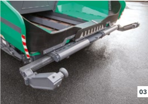
01 Sélection des niveaux de régime 02 Direction à angle de braquage présélectionné 03 Truck Hitch
