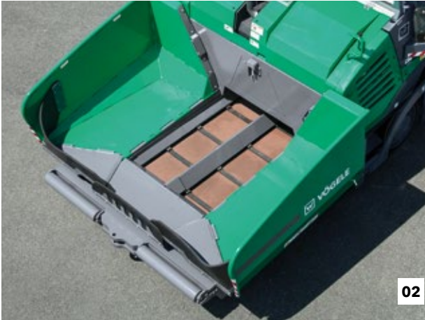
01 Ailes de trémie à commande indépendante. 02 La grande trémie réceptrice offre une capacité de 13 tonnes (14,3 tons).
