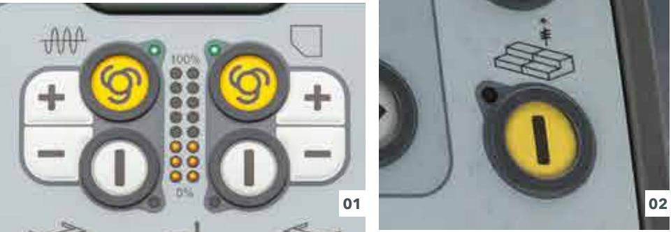
01 Compactage 02 Soutènement de la table (en option)
