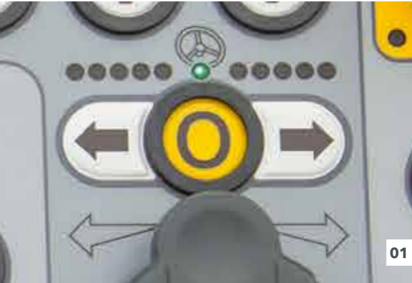
01 Pour les longues courbes à rayon constant, l'angle de braquage souhaité peut être présélectionné à l'aide des touches fléchées.
