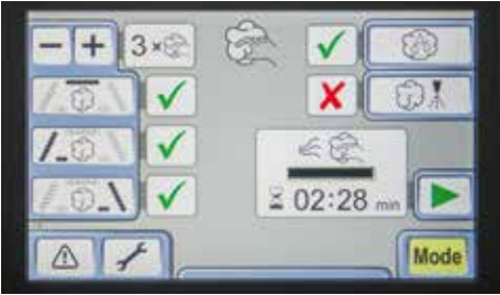
“清洁”界面 根据积垢程度，可显示清洁循环次数。管路可独立清洁。最后的清洁循环中可添加一种保护剂。一旦启动，清洁过程便全自动进行。
