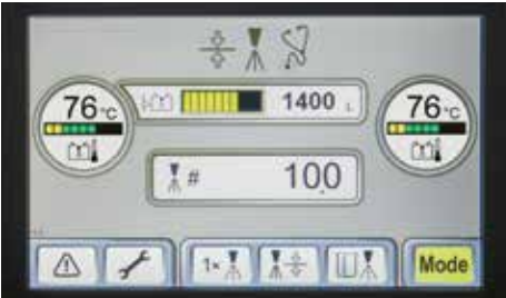
“喷嘴设置”界面 安装的喷嘴尺寸可通过该菜单输入，并且在此可测试喷嘴以及检查洒布量。
