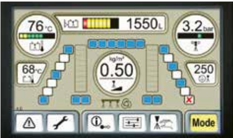
“喷洒”界面 整个喷洒过程由此监控。机手可监控所有设置及参数，例如喷嘴状态（运行/堵塞/关闭）和喷洒压力。
