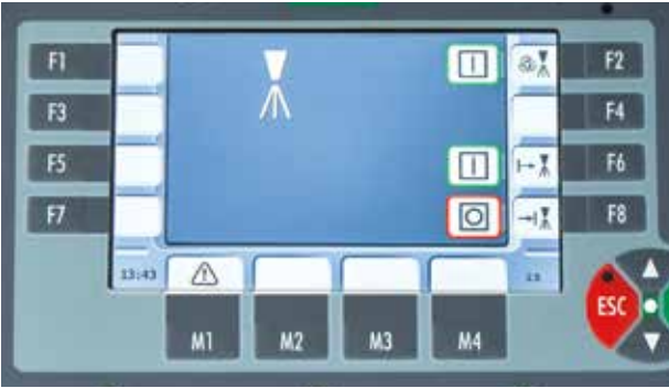
“开始工作”和“停止工作”自动功能 “开始工作”(F6) 和“停止工作”(F8) 这两个舒适的功能，确保了摊铺机始终在规定的位置开始或停止喷洒，并且在整个摊铺宽度范围内继续施工。
