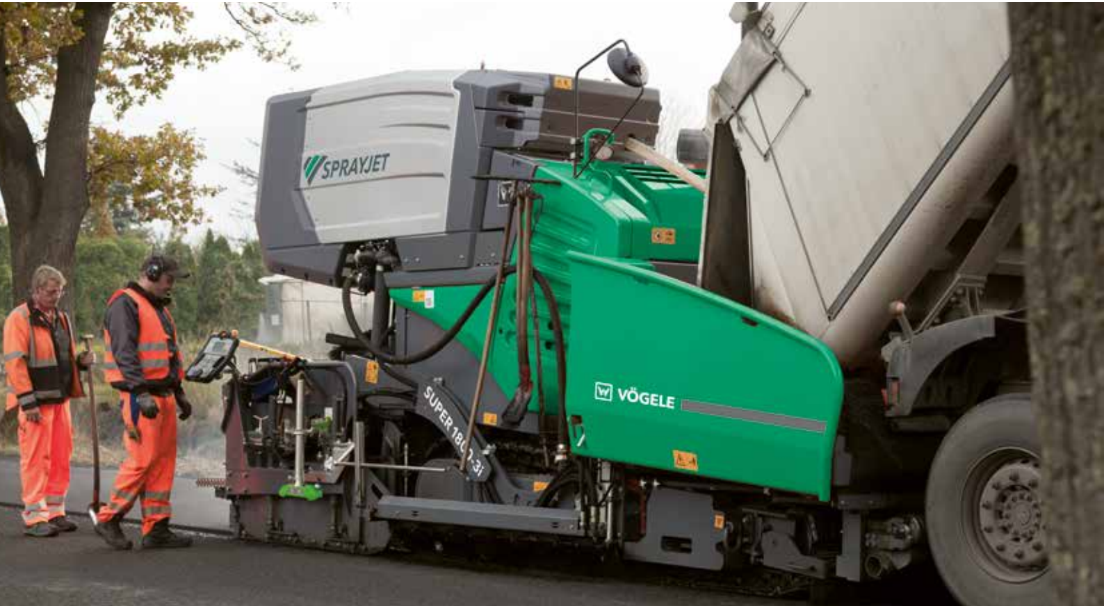
大型乳化沥青罐， 容量达 2,100 L。 附加的乳化沥青罐， 容量达 5,000 L。
