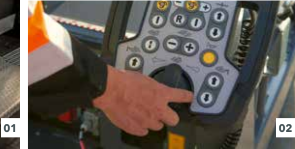
01 高对比度的彩色显示屏，确保了即使在照明不好的工况下，也能理想的读取信息。另外，向下倾斜的大功率 LED 照明灯使机手对边板相关区域拥有良好视野。 02 通过便捷的熨平板宽度控制开关，对熨平板宽度进行调节。
