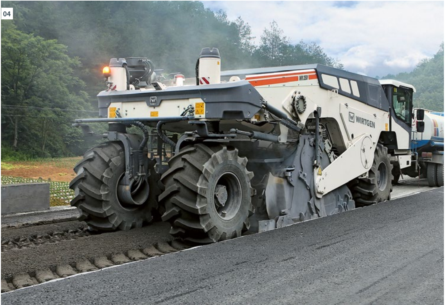
01 - 04 冷再生施工中，强劲的铰刨和拌合转子铰刨受损路面。破碎后的材料与喷入的粘结剂高效拌合，生成均匀的再生混合料，直接用于摊铺和压实。
