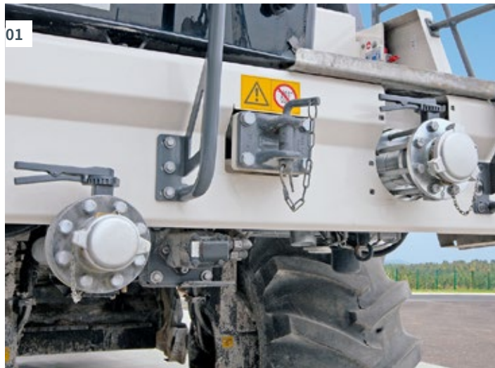
01 用于泡沫沥青的加注连接装置易于接近。
