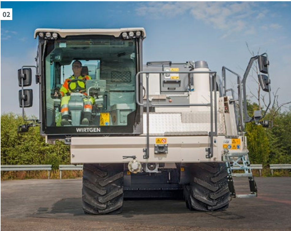
01 – 02 驾驶室可以液压平移至机身右侧，使机手能够更加方便地观察到行驶在机器前方的再生机组情况。
