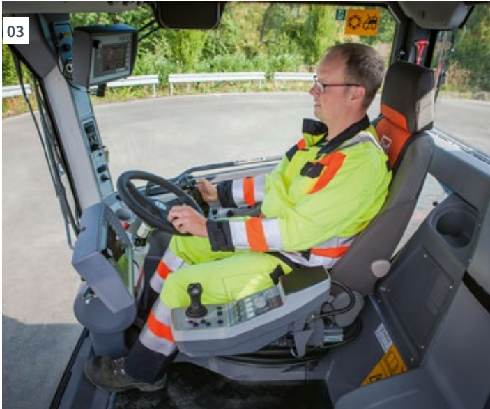
03 - 04 机手可以独立调节座椅，从而确保以舒适的坐姿操作机器。
