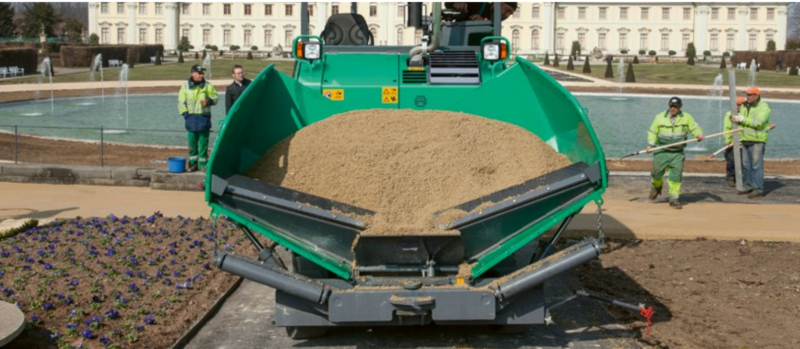
Большой приемный бункер вместимостью 10 тонн
