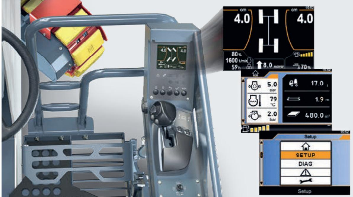
01 所有的重要机器功能和施工参数都显示在布置清晰的彩色显示屏上,使得机手单手就能完全掌控。
