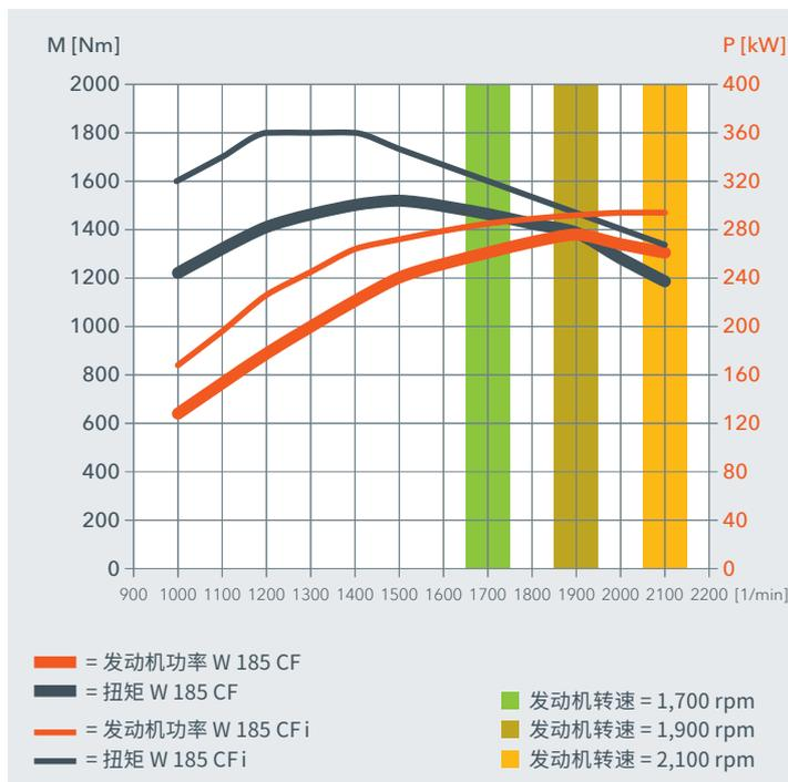
三档铣刨鼓转速对应不同发动机转速，降低油耗的同时确保了超高的铣刨性能。
