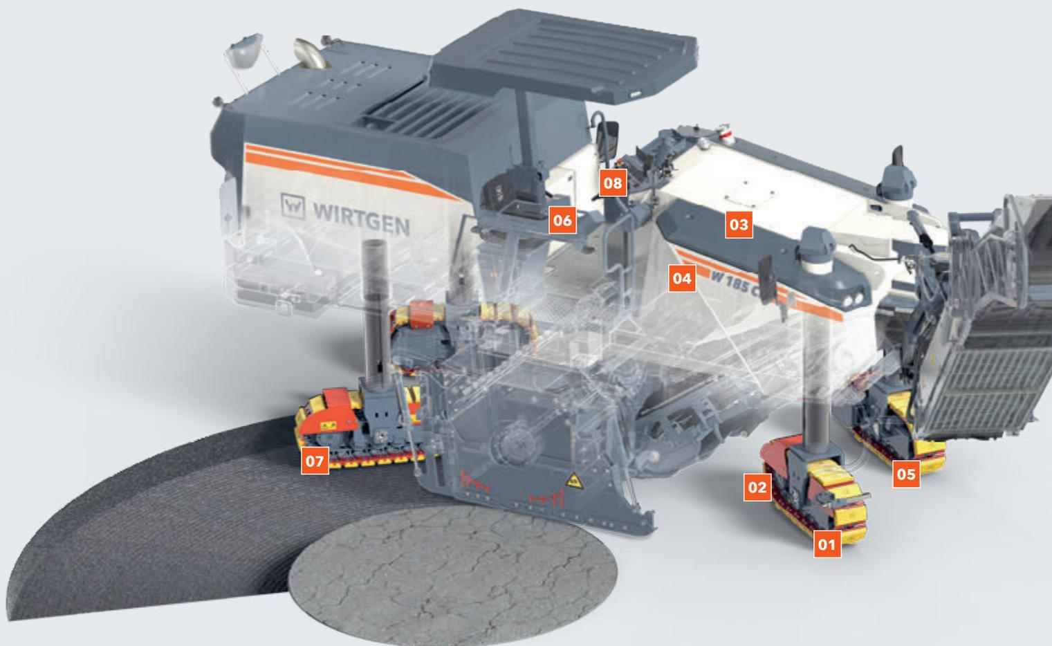
**01** 四个支腿液压缸联动，快速而精准地调整支腿高度，从而消除路面的不平整。
