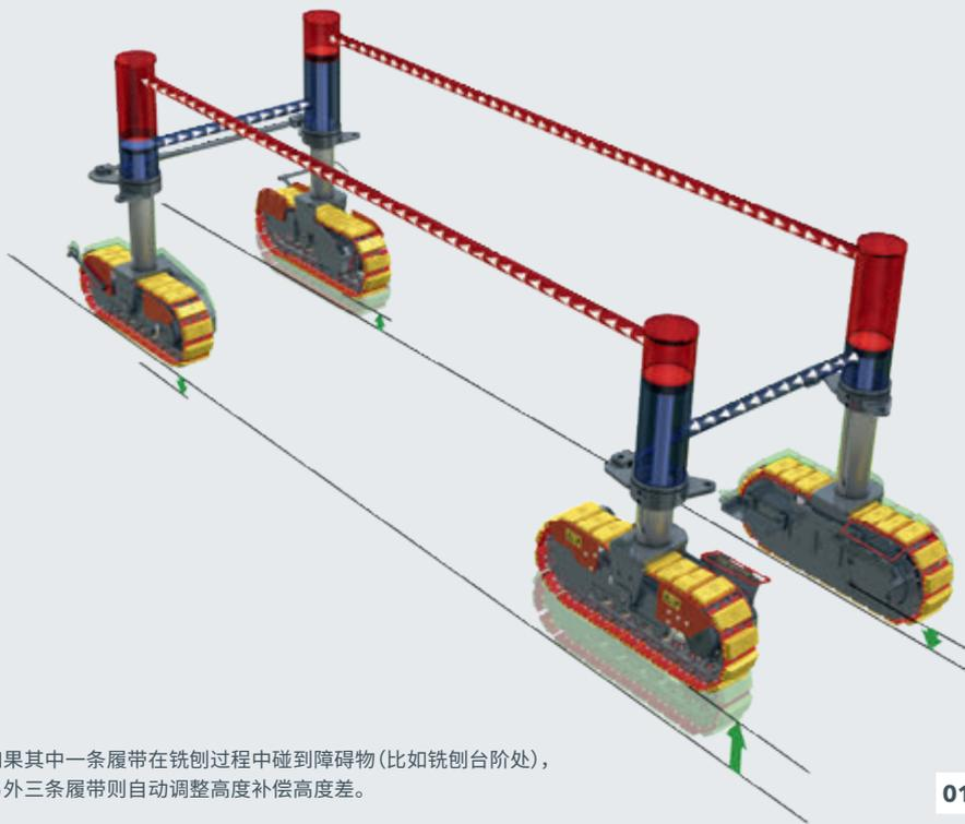
如果其中一条履带在铣刨过程中碰到障碍物(比如铣刨台阶处)，另外三条履带则自动调整高度补偿高度差。
