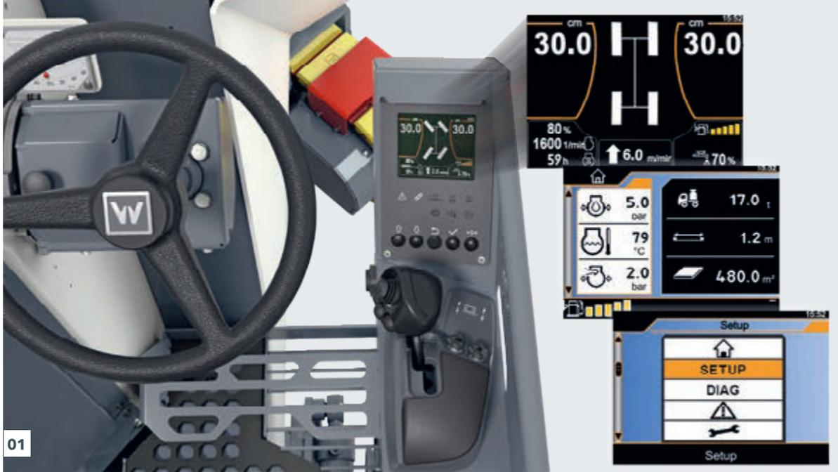
01 所有的重要机器功能和施工参数都显示在布置清晰的彩色显示屏上，使得机手单手就能完全掌控。
