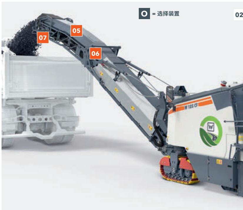
01 维特根铣刨转子通用性高，具有许多创新功能，其铣刨深度高达 330 mm。FCS 铣刨转子快换系统允许兼容 600 mm、900 mm 以及 1200 mm 的铣刨转子，灵活性非常高。02 高效装载铣刨料。
