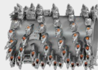
Tambour de fraisage standard Largeur de fraisage : 1 300 mm Profondeur de fraisage : 0 - 330 mm Écartement des pics : 15 mm
