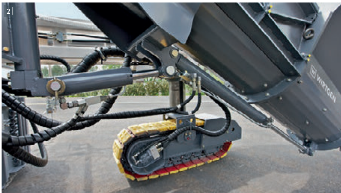
2 | 输料螺旋和输料皮带均可从驾驶台上液压式调节。
