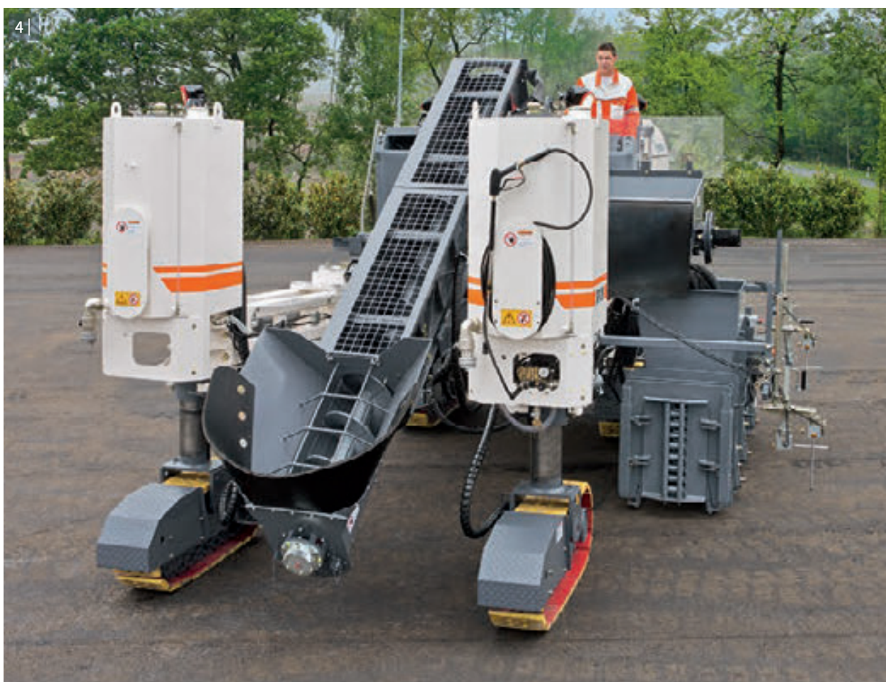
3 | 横向液压伸缩的输料螺旋可以发挥暂时存贮材料的作用，是输送大量混凝土的理想选择。
