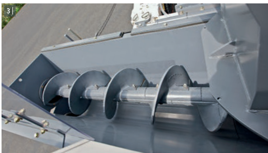
2 | 输料螺旋和输料皮带均可从驾驶台上液压式调节。
