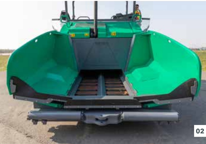
01 择发动机转速 02 只需按下按键, 料斗两侧的料斗壁便能够单独折叠或一起折叠。
