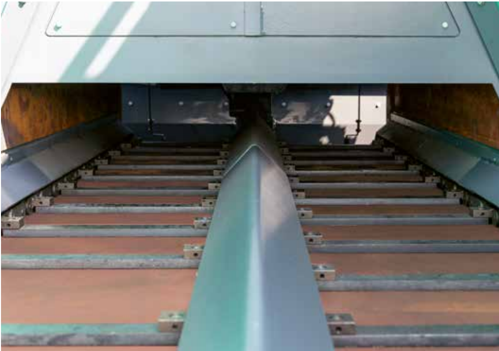
只需按下按键, 刮板输料器可进行短时反转。混合料的回送会自动停止。刮板输料器可以快速切换到无负荷功能。
