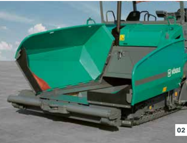
01 择发动机转速 02 只需按下按键, 料斗两侧的料斗壁便能够单独折叠或一起折叠。
