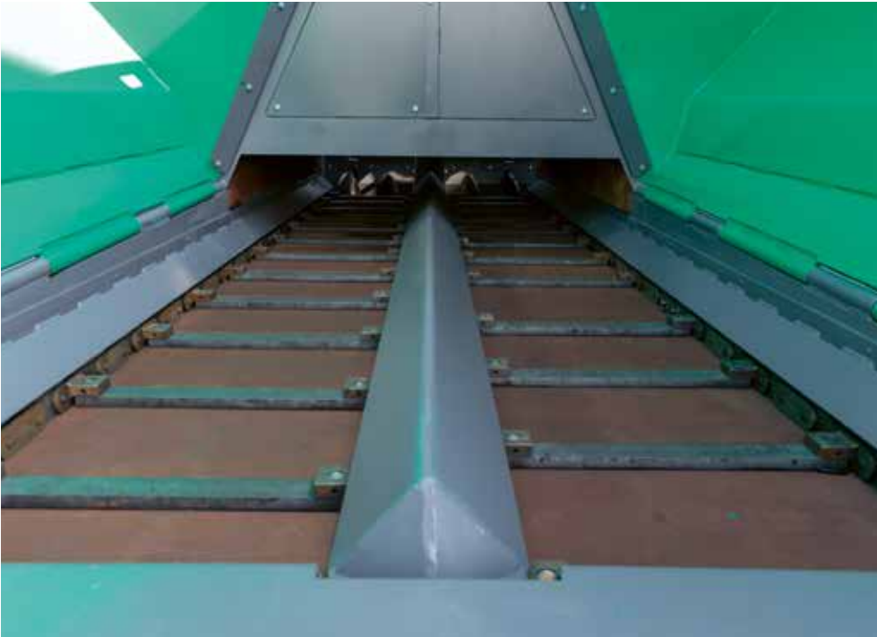
只需按下按键, 刮板输料器便可进行短时反转。混合料的回送会自动停止。刮板输料器可以快速切换到无负荷功能。
