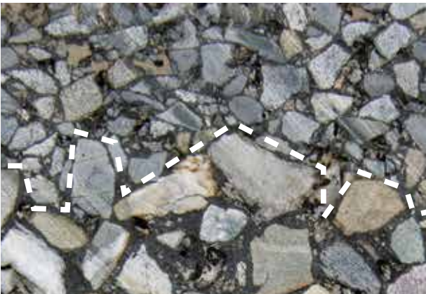
Hervorragende Verklebung und Verzahnung von Binder- und Deckschicht.
